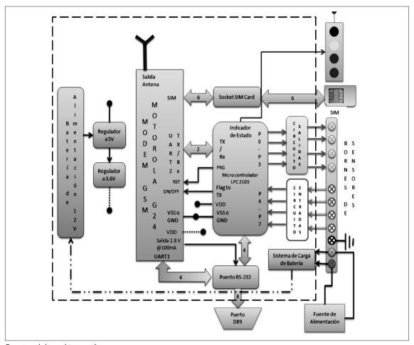
transmitir o recibir las señales de los usuarios predeterminados. El diagrama que describe el módulo de monitoreo y control es mostrado en la figura 5.
