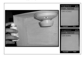
fluye una pequeña corriente iónica sensible a la presencia del humo. Cuando el humo entra en la cámara de ionización, las partículas alfa quedan prácticamente inmovilizadas por los productos de la combustión, hecho que disminuye notablemente la corriente eléctrica [15].
