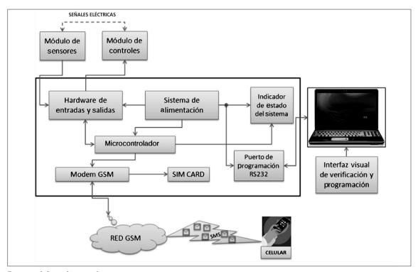
sensores, módulo de transmisión, recepción integrada al control.
