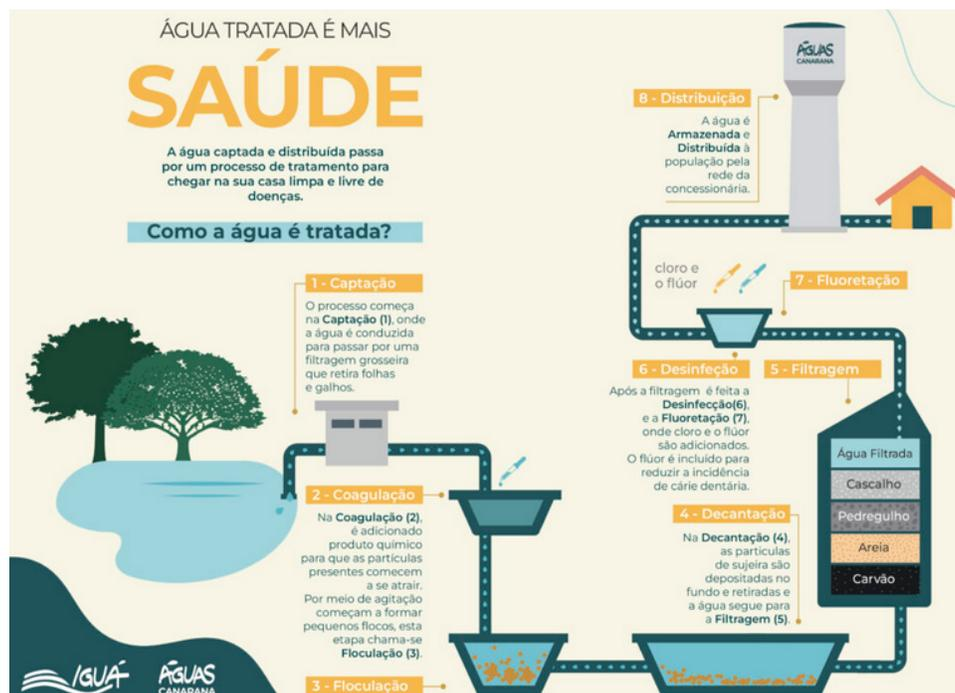
Figura 2: Fluxograma sobre o tratamento da água.
