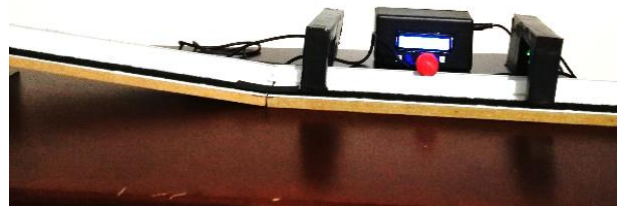
Figura 1. Sensores de tiempo, superficie de desplazamiento y esfera. Fuente: Elaboración propia
