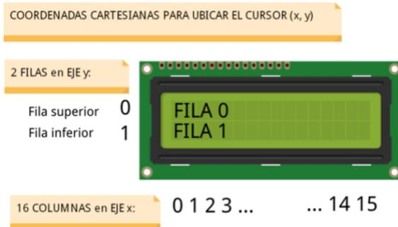
Figura 3. Funcionamiento de una pantalla LCD. **Fuente:** <https://educarparaelcambio.com/arduino/reto-4-liquid-crystal-display-pantalla-lcd/>
