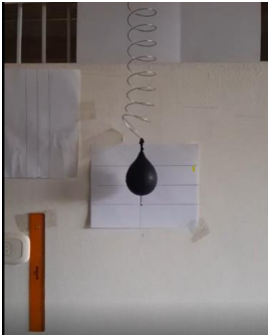
Figura 4. Montaje del sistema masa – Muelle.
