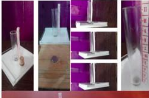
Ilustración 10. Captura del permeabilímetro magnético cilíndrico y su mecanismo. Fuente: Autoría del docente investigador.
