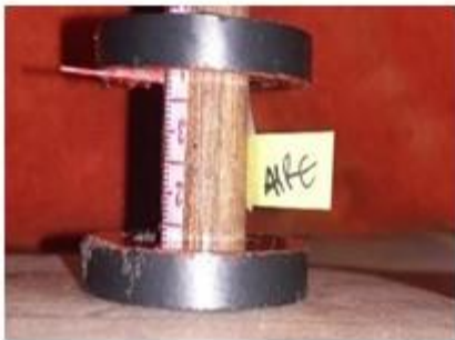
Ilustración 9. Captura del permeabilímetro angular. Fuente: Autoría del autor.
