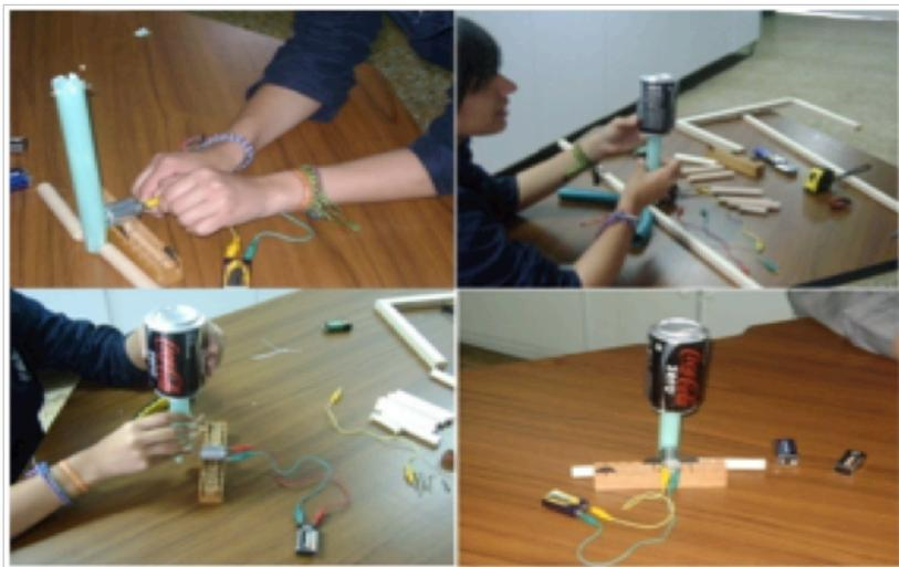
Figura 12. Construcción del generador de van de Graf por parte de las estudiantes.
