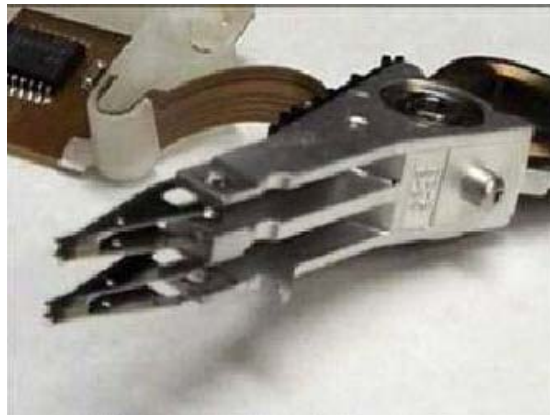
Fig. 4.b. Brazo actuador, en cuyo extremo se encuentran las cabezas de lectura-escritura.
