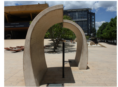
Fig. 3c. El reloj de Sol cilíndrico en el Parque Explora de Medellín. Puesto que el cilindro no es transparente, en la parte superior del gnomon hay un espejo que refleja el haz de luz hacia la superficie interior
