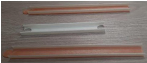
Figura 2. Piezas impresas en 3D con características de ensamblaje. Fuente: Grupo Proyecto REMSI, Universidad de Cundinamarca, Universidad Nacional de Colombia.
