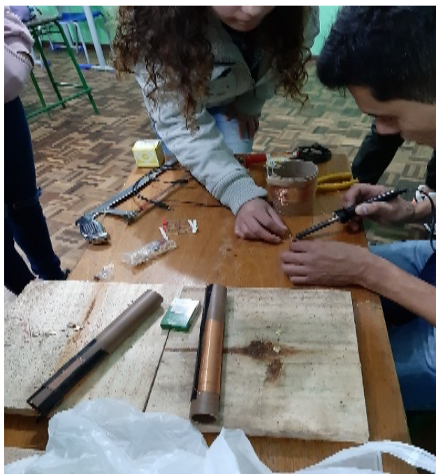
Figura 2. Estudantes confeccionando o rádio de galena sem utilização de pilhas ou fonte. Fonte: autores (2021).
