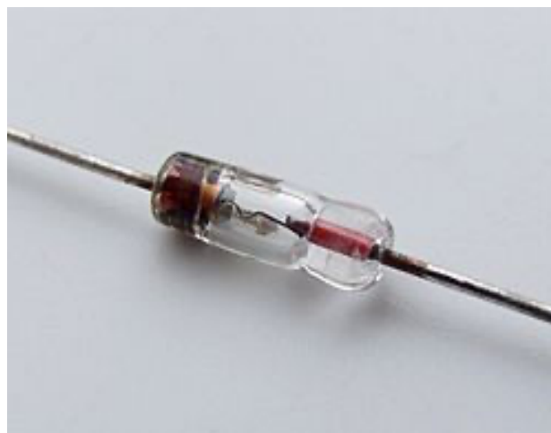
Figura 8. Diodo de germânio utilizado no experimento. Fonte: autores (2021).
