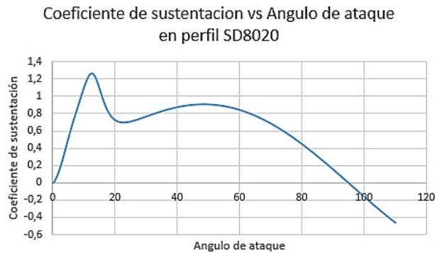
**Figura 9.** Comportamiento aerodinámico perfil SD8020 (coeficiente de sustentación).
