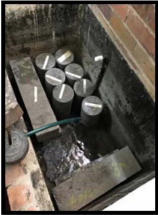
Figura 1. Curado de cilindro en laboratorio.
