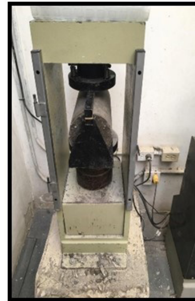
Figura 4. Ensayo de tracción indirecta.
