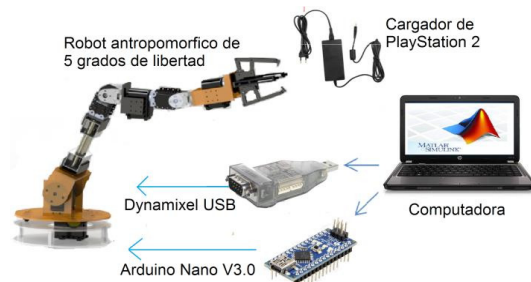
Figura 5. Diagrama de conexiones del sistema de clasificación
