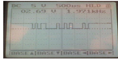
Fig. 26. Captura de un byte transmitido por el Arduino UNO a 31250 bps, con 5 V/div vs. 500 µs/div.
