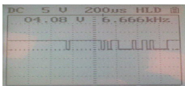
Fig. 25. Captura de un byte transmitido por el Arduino UNO a 9600 bps, con 5 V/ div vs. 200 µs/div.
