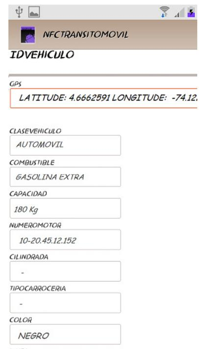
Figura 8. Ventana de identificación de TAG NFC de vehículos (Campos superiores)
