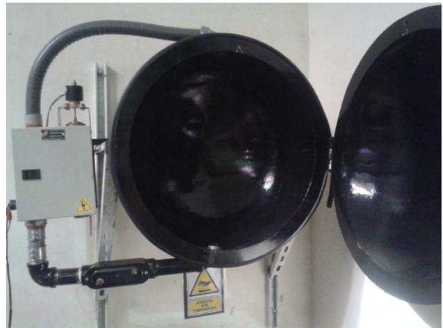
**Figura 16.** Cámara de ensayos termoeléctricos.
