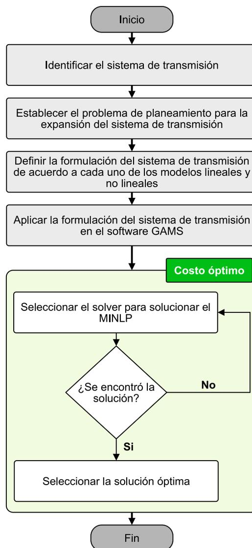
**Figura 3.** Metodología para determinar los costos de expansión de sistemas de transmisión
