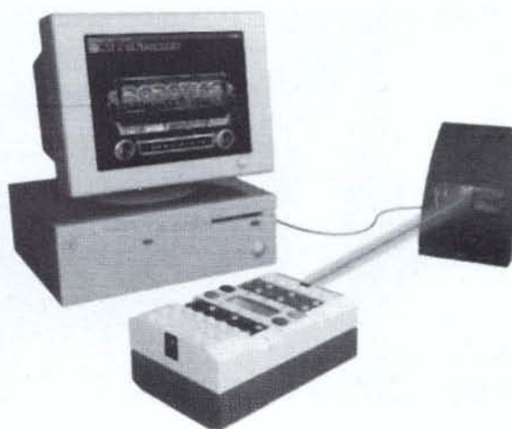
Figura 6. Comunicación infrarroja bidireccional (IR) entre el PC y el RCX
