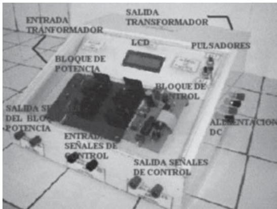
**Figura 12.** Disposición final del inversor monofásico didáctico.
