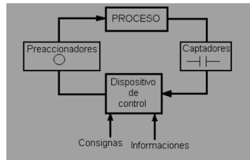
Figura 2. Nivel de automatización elemental, bucle cerrado.
