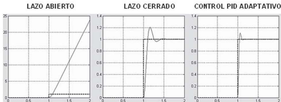
Figura 6. Respuesta del sistema controlado mediante PID adaptativo
