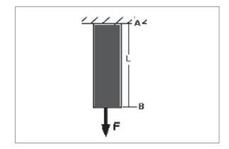
Figura 2. Caso de ejemplo: carga axial, esfuerzo y deformación
