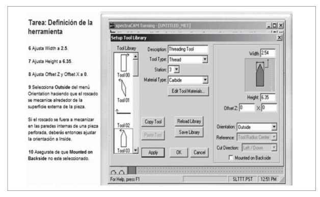
Figura 6. Imagen del archivo .pdf de estudio del Software CAD/CAM Fuente: elaboración propia.
