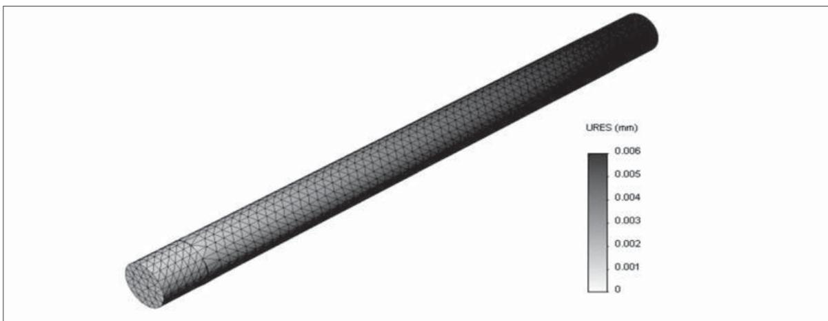
**Figura 4.** Comportamiento de una barra a tensión, usando MEF
