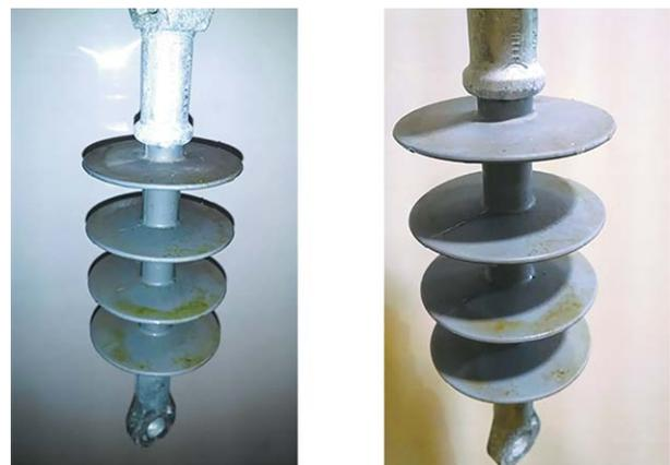
**Figura 3.** Aislador ANSI DS-15 después de la biocontaminación con *Chlorella vulgaris*
