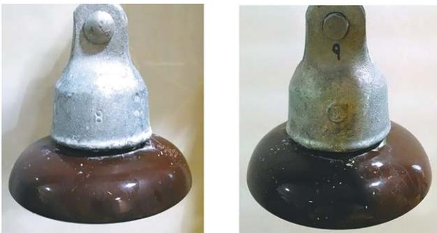
**Figura 2.** Aislador ANSI 52-1 después de la biocontaminación con *Chlorella vulgaris*
