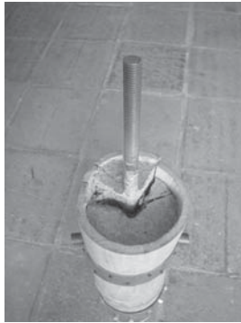
Figura 20. Falla del aglomerado EHL
