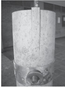
Figura 20. Falla del aglomerado EHL
