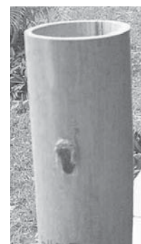
Figura 9. Cortante || en un plano
