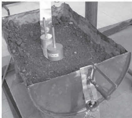
Figura 8. Probeta de pruebas y el electrodo en forma de suela de zapato utilizados para determinar la impedancia de aterrizamiento.
