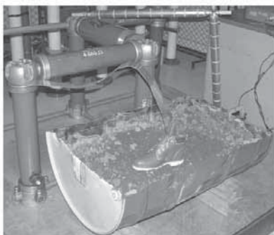
Figura 17. Montaje experimental 2 para la aplicación de impulsos tipo rayo a un zapato real.
