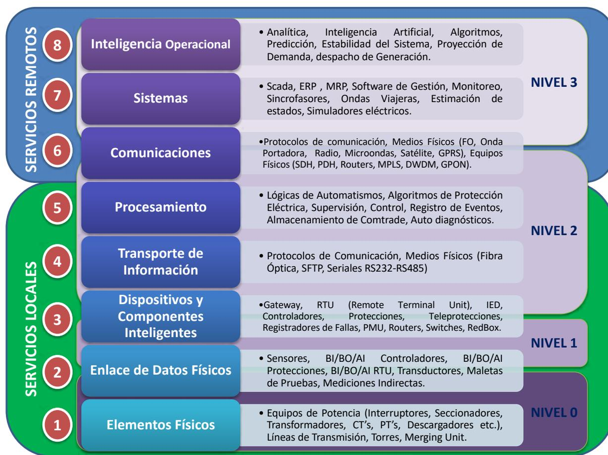
**Figura 1.** Modelo del funcionamiento desde la perspectiva de ciberseguridad
