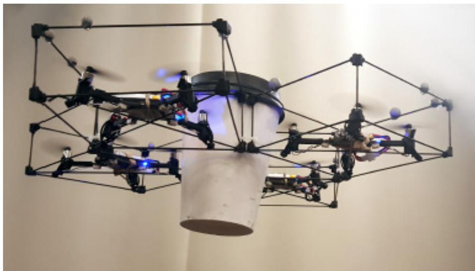
**Figura 12.** Flying gripper transportando una taza de café
