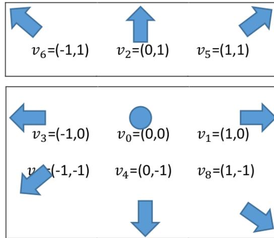
Figura 1. Modelo de velocidad 2DQ9 para Lattice Boltzmann
