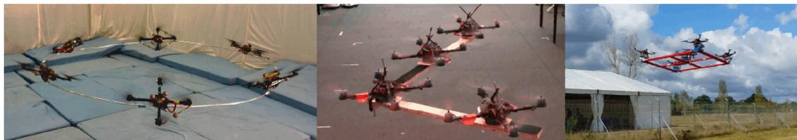
**Figura 10.** Trabajo cooperativo entre UAV para el transporte de carga
