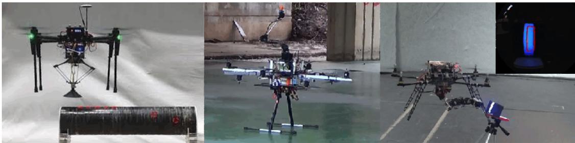
**Figura 6.** UAV realizando manipulación área (izq.). UAV para la inspección de vigas (der.)
