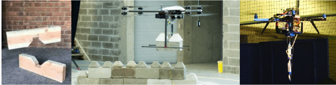
Figura 4. Módulos de madera (izq.). UAV transportando módulo de fácil ensamblado (med.). UAV con dispensador de espuma expansiva (der.)
