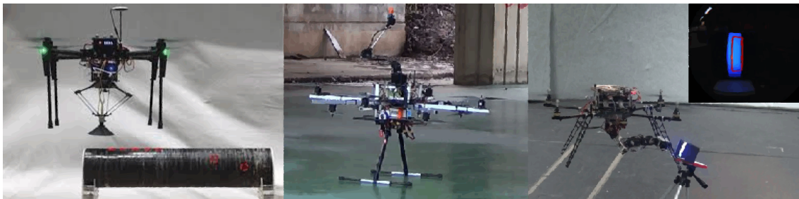
Figura 6. UAV realizando manipulación área (izq.). UAV para la inspección de vigas (der.) Fuente: ajustado de Chermpayong et al. (2019) ; Jiménez-Cano et al. (2017) , y Kim et al. (2016) .
