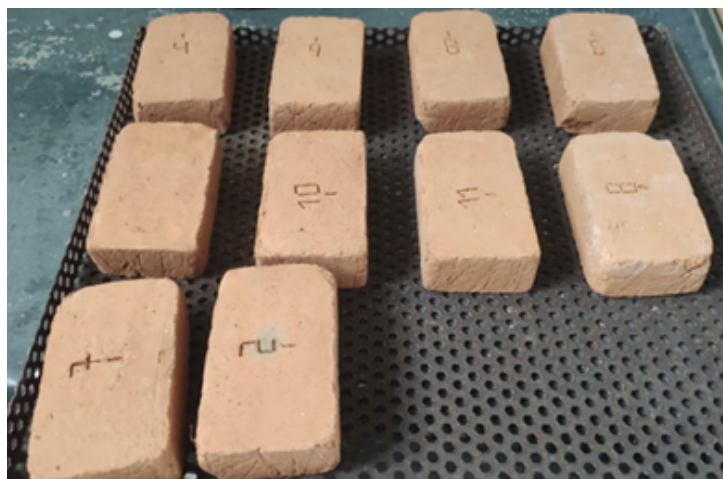
Figura 1. Ladrillos fabricados con adición de cenizas de fondo
