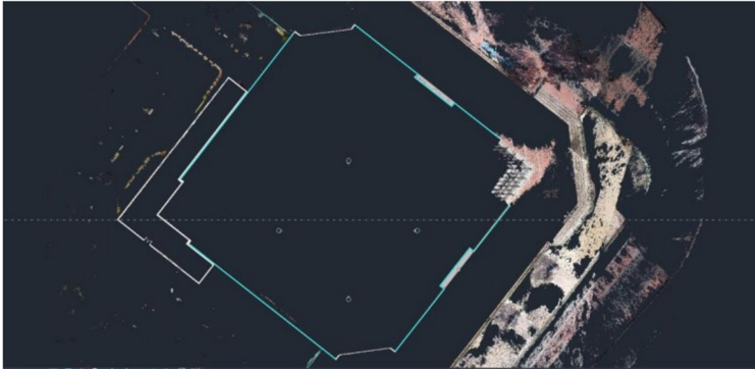
Figura 12. Proceso para insertar un muro en Revit
