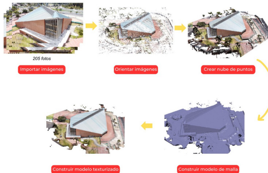
Figura 6. Esquema de procesamiento de imágenes con el software de fotogrametría.
