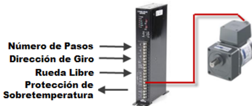
Figura 9. Funcionamiento básico del motor.
