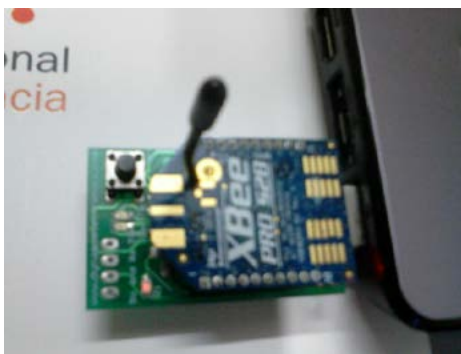
Figura 7. Configuración del XBee-PRO® S2B ZB como router con el programa X-CTU.
