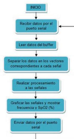
**Figura 18.** Diagrama de flujo de las funciones que realiza el software diseñado en LabViewTM.
