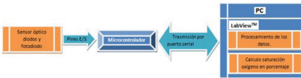
**Figura 4.** Diagrama de bloques del sistema de oximetría basado en interfaz directa.
