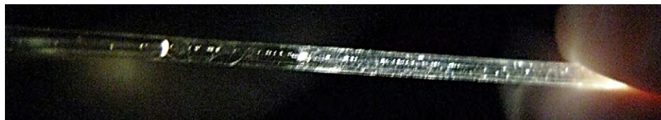
Figura 11. Paso de luz blanca a través del dimetilformamida (DMF)
