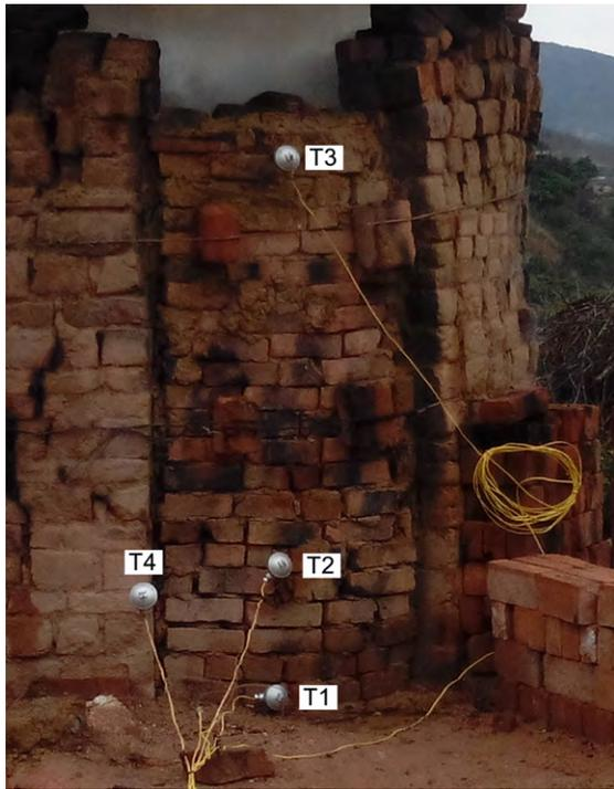
**Figura 1.** Termopares instalados por niveles en el horno
