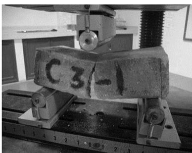
**Figura 5.** Ensayo de flexión
