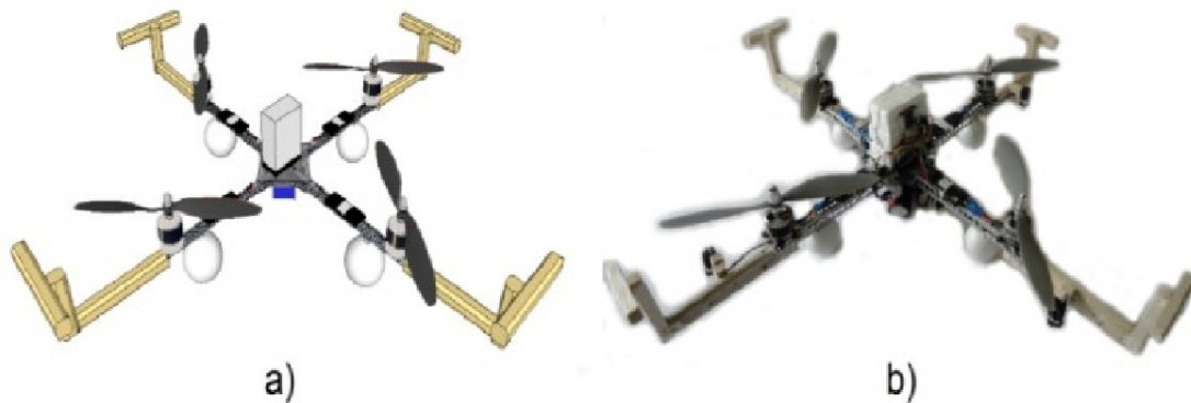
Figura 5. Diseño del prototipo (a) modelo virtual Google Sketchup (b) modelo real
