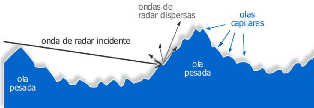
Figura 1. Dinámica del mar: olas capilares moduladas por olas pesadas o gravitatorias
