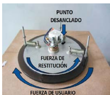
Figura 4. Dirección de las fuerzas que actúan cuando hay colisión virtual
