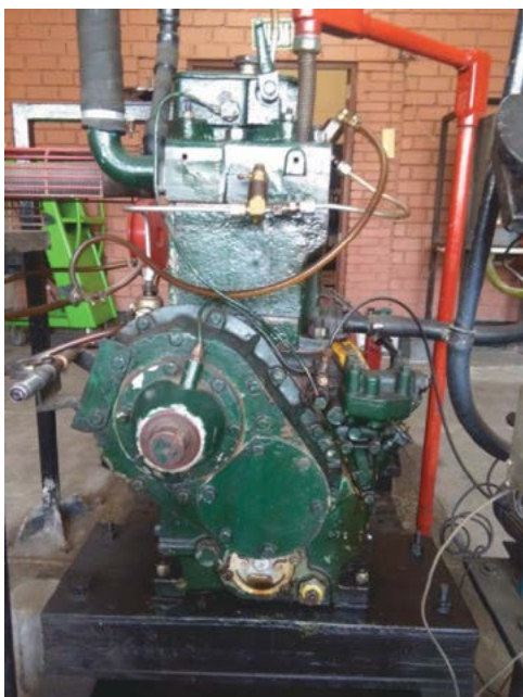
Figura 2. Motor diésel Petter
