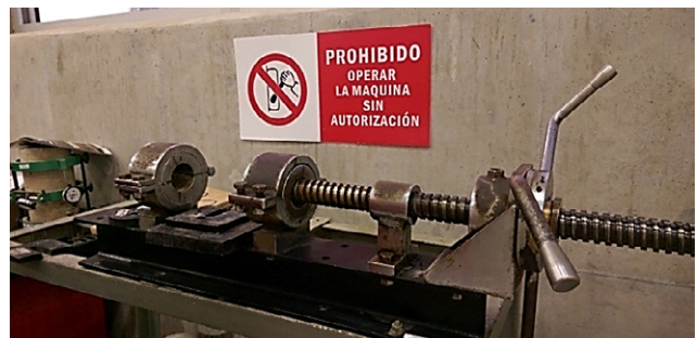
Figura 5. Máquina utilizada para sacar las briquetas del molde
