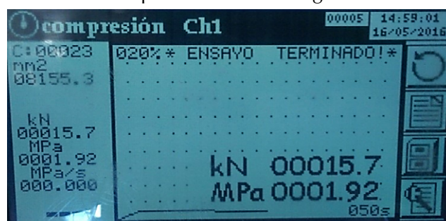
Figura 7. Lectura No. 17 de carga máxima en la máquina de compresión marca Controls modelo 04700/er
