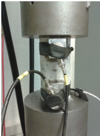
Figura 3. Configuración experimental y equipo de medición de EA
