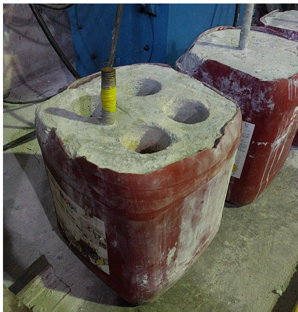
Figura 2. a. Croquis de la composición de las probetas donde se observan los diferentes estratos y la guía de onda que los atraviesa. b. Probeta con cuatro perforaciones y guía de onda cementada.
