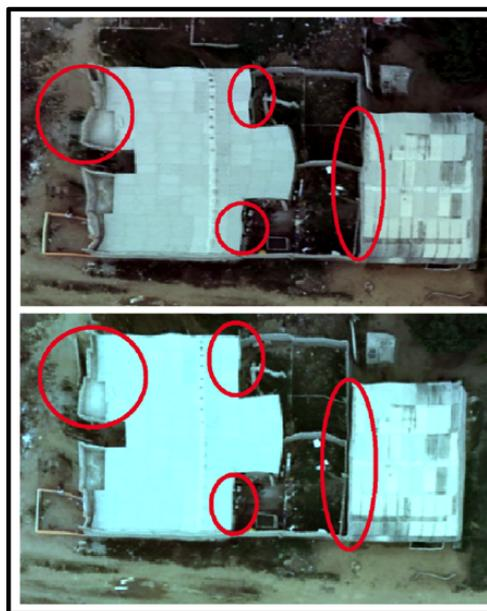
**Figura 7:** Comparación de un edificio entre la ortofoto con GSD de 0,018 m y 0,045 m (arriba y abajo, respectivamente)
