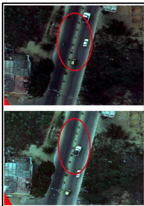
**Figura 6:** Comparación de la vía entre la ortofoto con GSD de 0,018 m y 0,045 m (arriba y abajo, respectivamente)
