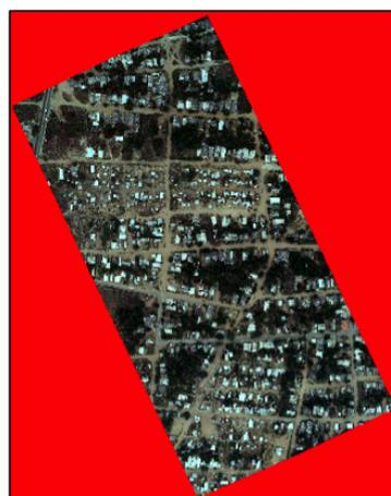
**Figura 4:** Ortofoto con GSD de 0,045 m elaborado con el *software Inpho*.
