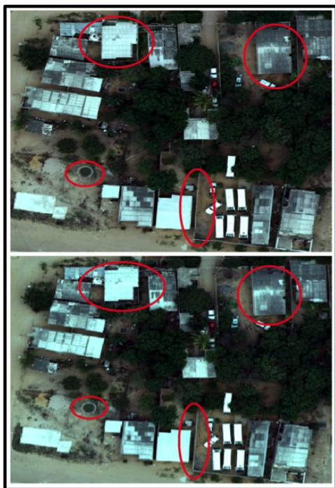
**Figura 8:** Comparación de una región de predios entre la ortofoto con GSD de 0,018 m y 0,045 m (arriba y abajo, respectivamente)
