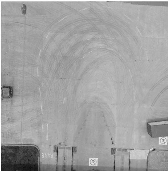
Figura 2: Trayectoria de giro tractocamión C3S3
