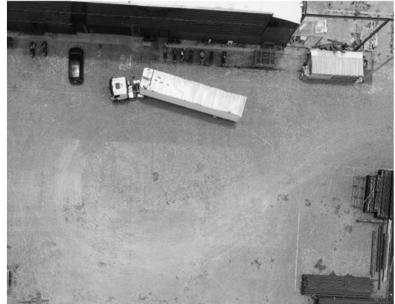
Figura 3: Trayectoria de giro tractocamión C3S2
