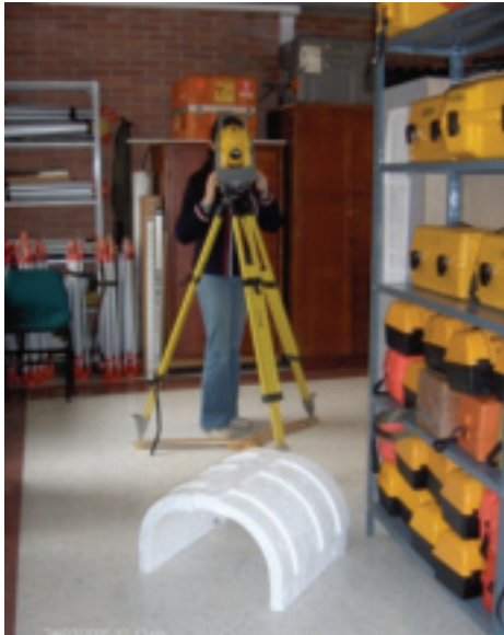
Figura 3. Referenciación de los puntos de plomo sobre la caja de calibración.
