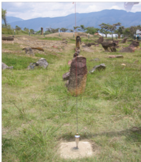
Figura 2. Vértice geodésico materializado dentro del Parque Arqueológico Saquenzipa
