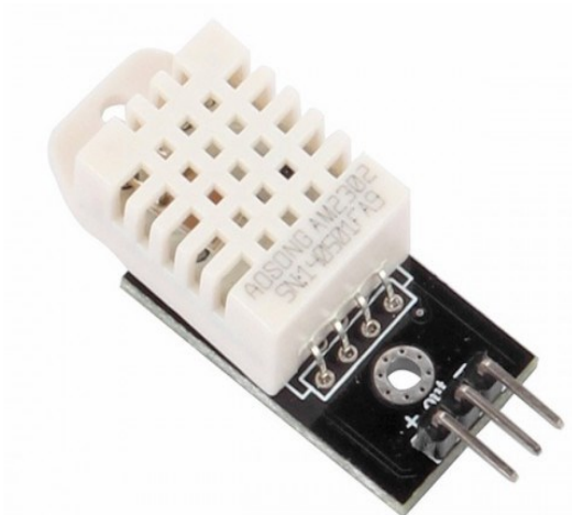
Figura 1. Sensor de Humedad y Temperatura del ambiente DHT22, tomado de tienda electrónica Robomart
