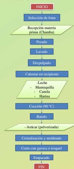
Figura 3. Flujograma para el proceso de obtención de dulces derivados de la fruta de Chamba.
