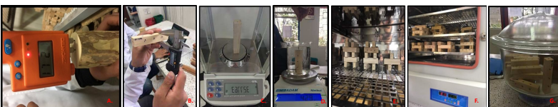
Figura 1. Métodos. A. Registro de CH; B. Medición de planos de estudio; C. Pesa; D. Volumen; E y F. Secado en estufa; G. Almacenamiento en cámara de sílica gel.
